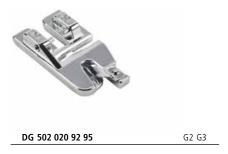
Эта специальная лапка служит для изготовления профессиональных подгибок. Она дважды подгибает ткань. Так образуется тонкий подрубочный шов, который затем аккуратно фиксируется иглой прямым стежком.
