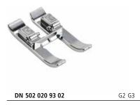
Открытая вышивальная лапка для системы двойной подачи ткани Dual Transport имеет углубление на задней стороне лапки для активирования встроенного верхнего транспортера. Таким образом обеспечивается равномерная подача при нескольких слоях ткани или плохо скользящих материалах.
